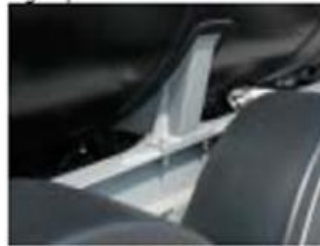
Berces reprenant les efforts passant par le train roulant et la structure d'attelage. Les pieds de berce sont fixés directement sur les longerons du train roulant avec cale isolante interposée pour limiter les ponts thermiques.
