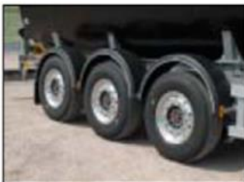
Train roulant choisi parmi les grandes marques européennes. Essieux 22,5" avec freins à disque, freinage à commande électronique (EBS).
